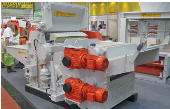
Bei Hackern ab 250 mm Einzugshöhe sind die Verschleißleisten unterhalb der Hackmesser serienmäßig
