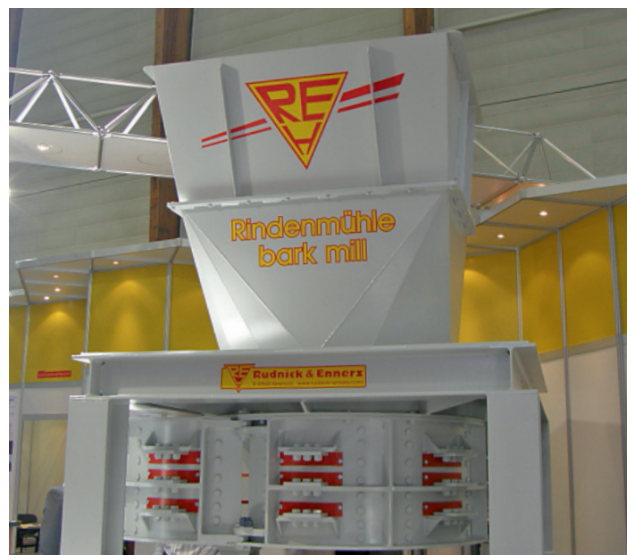
Die Rindenmühle RE-RMV 1250 mit schnell wechselbaren Gegenleisten wurde in Klagenfurt vorgestellt
