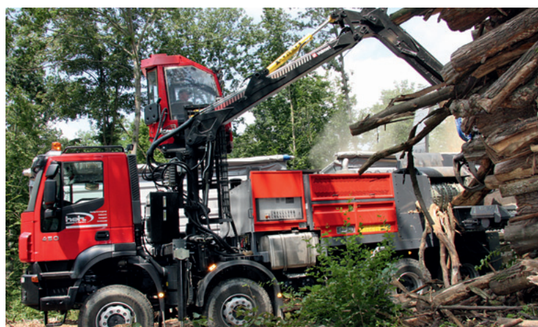
Aufbau von Hilfsrahmen, Kabine, Kran, Hydraulik und Elektrik stammt aus der Werkstatt von Karner & Berger. Fotos: Feichtner
