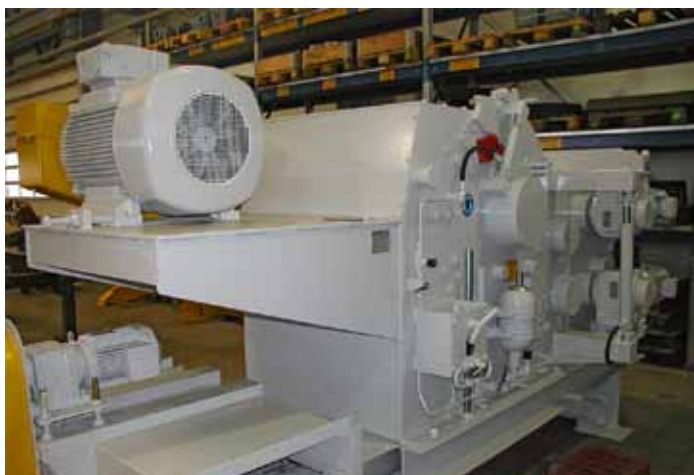
Der Trommelhacker RE-TH 250/700/5: Die Vorschubmotoren sind frequenz- geregelt, die Hacklänge kann verändert werden
