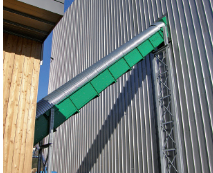
Der Kratzkettenförderer mit speziellen Kettenmitnehmern sorgt für eine zuverlässige Beschickung des neuen Heizkraftwerkes
