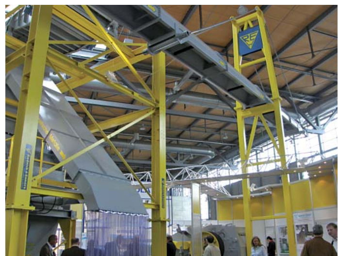
In 11 m Höhe wurde ein Teil eines Rohrgurttförderers abgehängt
