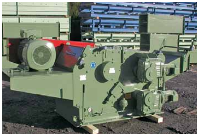
Vor Kurzem bei Spindler installiert: Hacker RE-TH 150/500 inklusive Vibrorinne und Kratzförderer lieferte Rudnick & Enners
