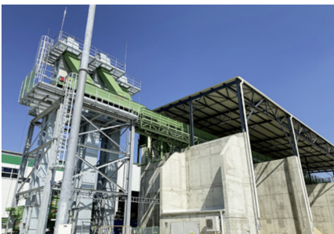
Transport der Hackschnitzel- und Sägespänefraktion mit Gurtbecherwerken des Typs RE-GBW
