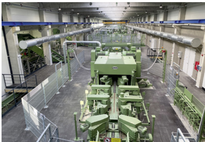
Linck-Linie: Einzug Vorschnittspaner mit Vorzentriereinheit und Doppeldrehwalzenpaar für automatische Eindrehung
