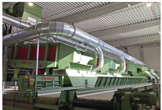
Absiebung nach drei Fraktionen mit Schwingsichtern des Typs RE-RS von Rudnick & Enners
