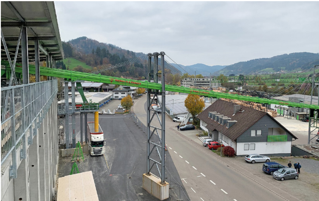
Der Rudnick & Enners-Rohrgurtförderer bringt das Restholz – Späne und Hackgut getrennt – über rund 100 m auf die gegenüberliegende Straßenseite in eine separate Lagerhalle
