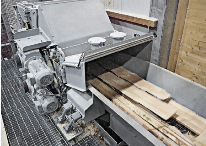
Rudnick & Enners lieferte an das Sägewerk Kolb einen Trommelhacker des Typs TH 300/700/3 mit 90 kW Antriebsleistung
