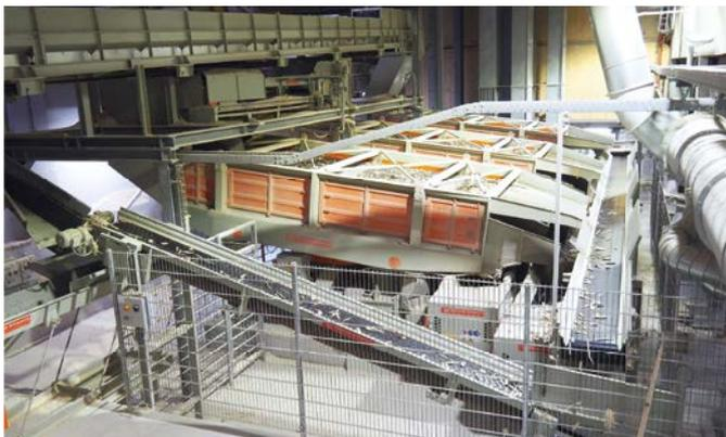
Für die Fraktionierung lieferte Rudnick & Enners drei Siebe neben der Sägelinie – zwei für Hackgut, eines für Sägespäne
