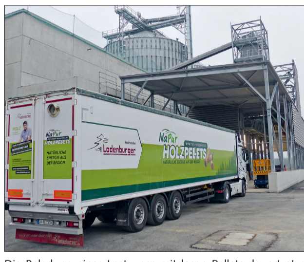
Die Beladung eines Lastzuges mit losen Pellets dauert etwa 20 Minuten. Gleichzeitig können zwei Lkw beladen werden.
