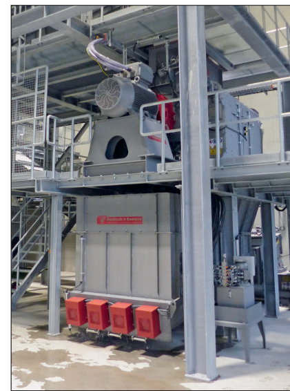
Nach der Sichtung erfolgt eine Nassvermahlung.
