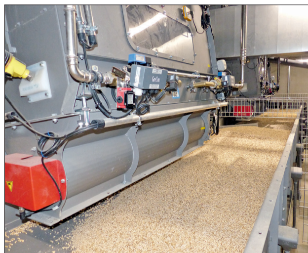
Pellets nach Verlassen der Kühler unter den Pressen
