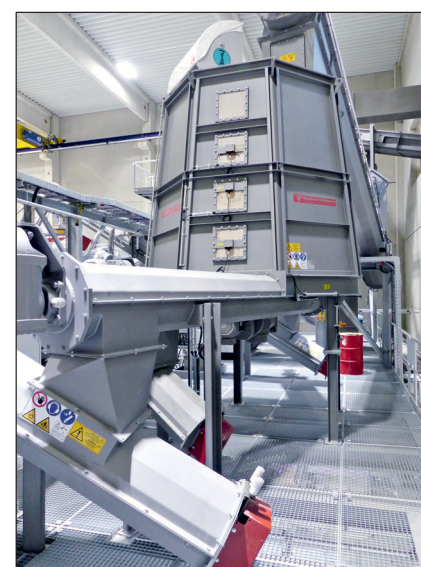
Aus dem Reifebehälter werden die drei Pelletpressen versorgt.
