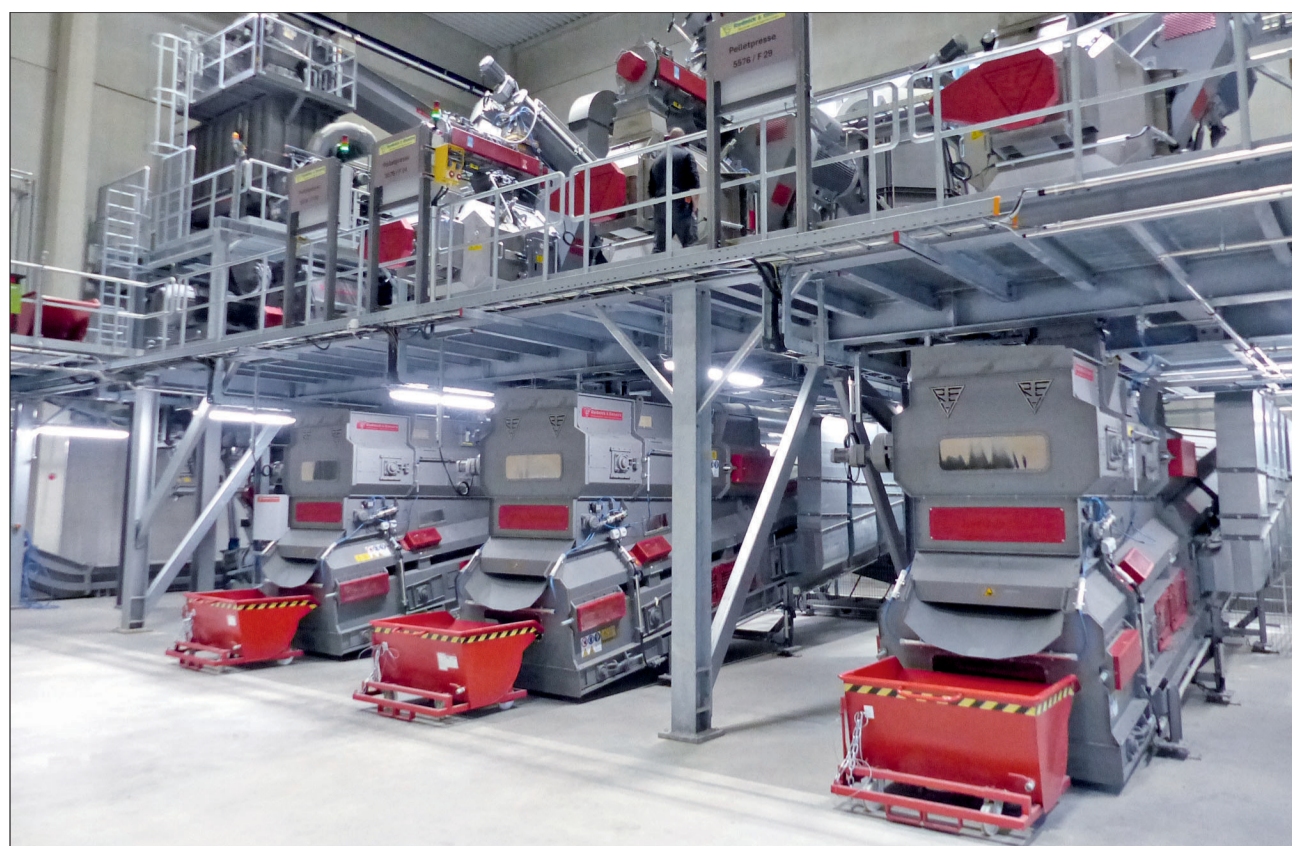
Trotz ihrer Leistungsfähigkeit von bis zu 160000 t/a ist die Pelletieranlage von Rudnick und Enners sehr kompakt.
