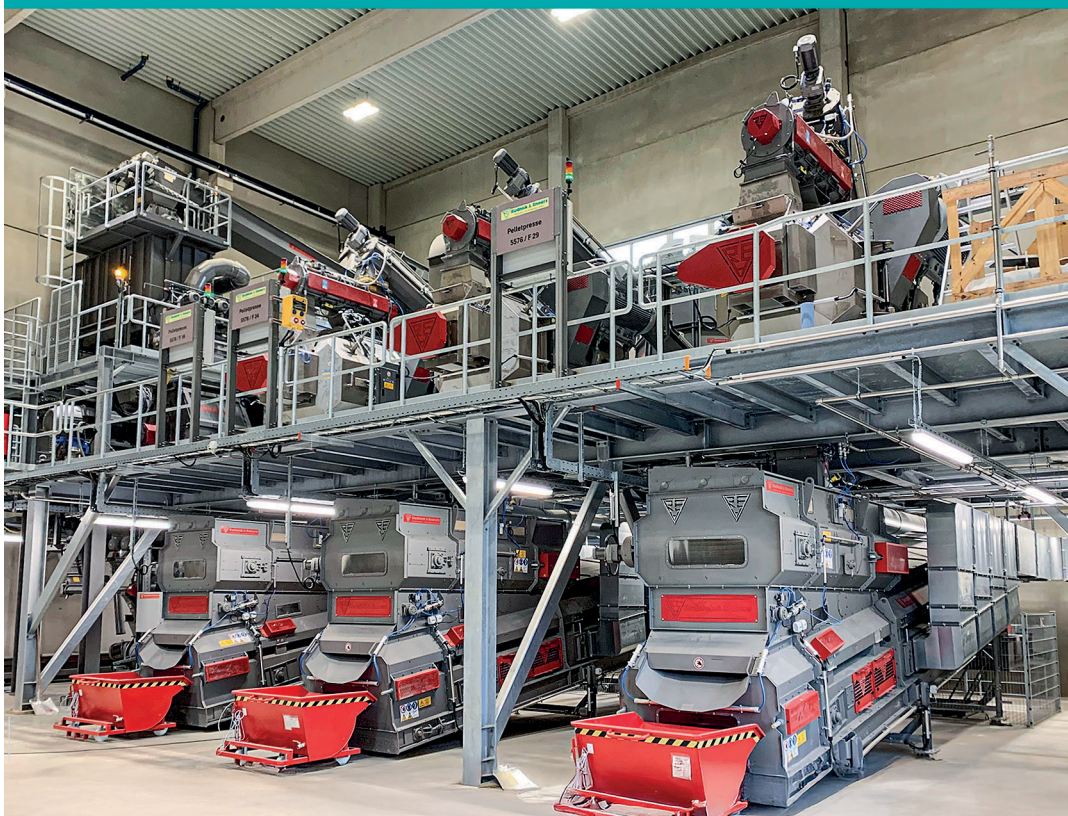
Der Durchlauf der Späne durch den Bandtrockner dauert etwa 15 bis 30 Minuten.
