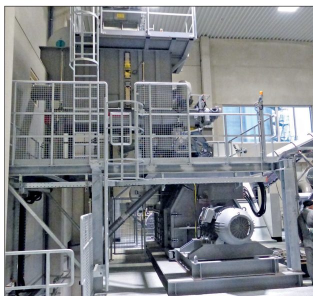
Hammermühle für die Trockenvermahlung
