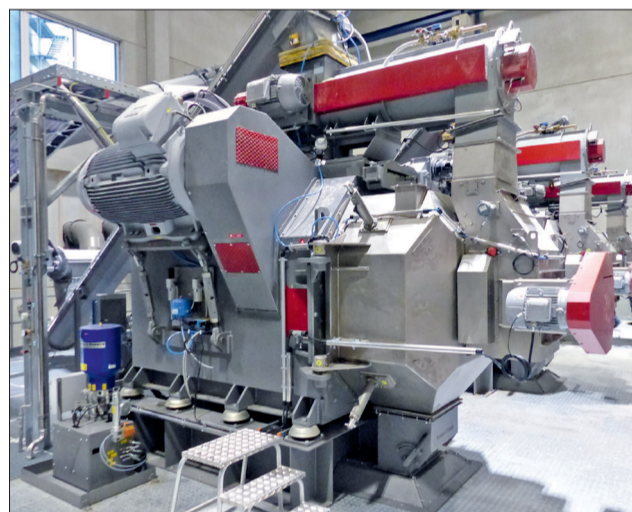
Jede der Pelletpressen hat eine Leistung von bis zu 7 t/h.
