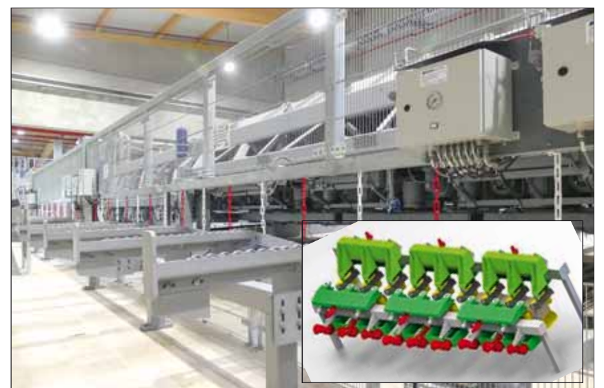
Der hier erstmals installierte Linck-Seitenbrettseparator „SEL“, der ganz ohne Förderketten arbeitet und stattdessen Transportrollen mit Riemenantrieb nutzt.
