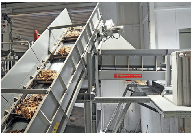
Über robuste Steigförderer gelangt die Rinde in Richtung des Schredders, von rechts kommen die Kappscheiben
