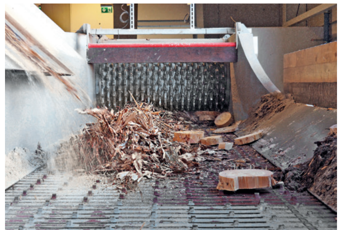
Schredder des Typs GSA 1.600 von Rudnick & Enners mit ausweichbarer Gegen-schneide
