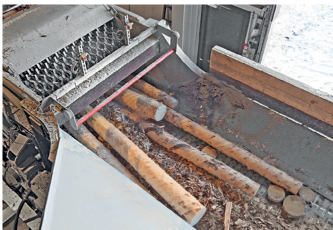
Der Schredder ist mit seinem 200 kW-Motor auch für die Zerkleinerung von Bruch- oder Faserholz ausgelegt
