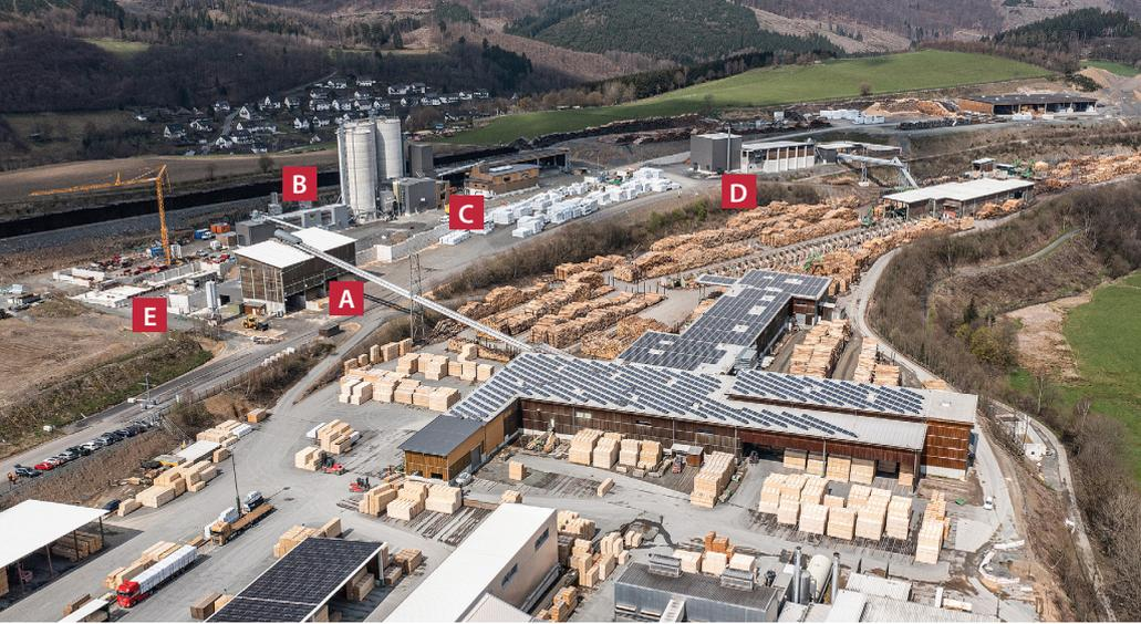
Blick auf Pieper Holz in Olsberg: Rohrgurtförderer vom Sägewerk in die Sägespänebunker (A), Aufbereitung des Sägerestholzes für die Pelletierung (B), die eigentliche Pelletierung sowie Lkw-Verladung und Absackstation (C), das neue Heizwerk (D) sowie die derzeit im Bau befindliche Industrieholz-anlage (E). Rudnick & Enners ist für das gesamte Restholzhandlung vom Rundholzplatz und das Sägewerk bis hin zur Pelletierung beziehungsweise die Verladung und Absackung zuständig
