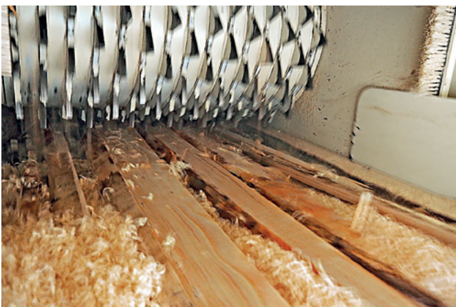
Mit dem starken Antrieb zerkleinert der Twin Chipper mühelos Schwarten und Spreißel und erzeugt perfektes Ausgangsmaterial für die Pelletsproduktion
