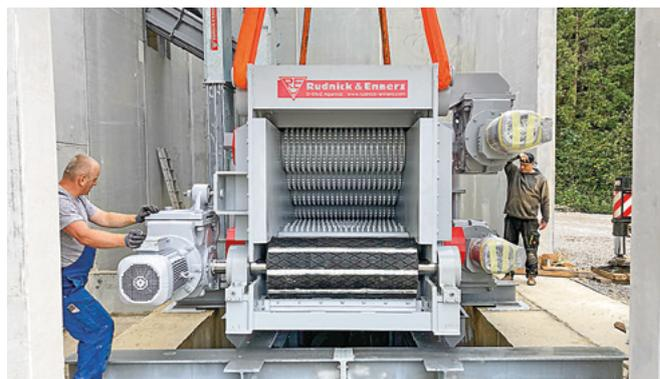
Aufgrund der guten Zusammenarbeit liefert Rudnick & Enners aktuell eine Trommelhackerlinie für Stammholz und Kappholz. Die Anlage soll zukünftig Biomasse für das Heizwerk und zusätzlichen Rohstoff für das Pelletswerk liefern
