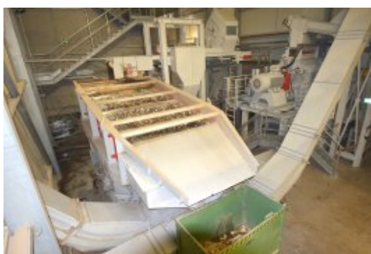
Tamis vibrant Rudnick & Enners avant passage de la matière à granuler au séchoir, photo FD
