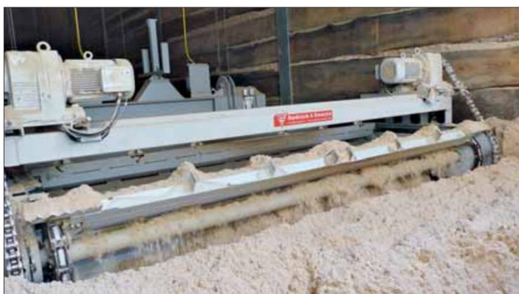
Hebe-Senk-Förderer in einem der Spänebunker
