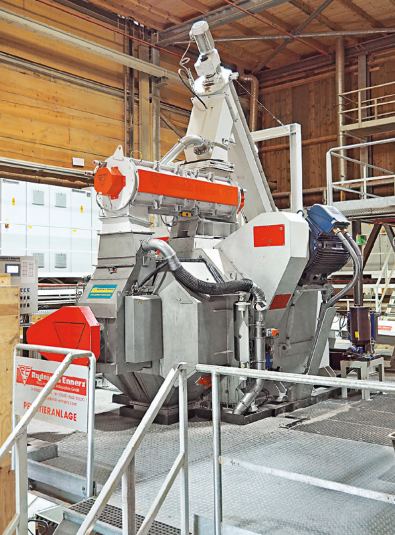
Seit November 2023 ist die neue Pelletspresse des Typs PM7 von Rudnick & Enners im Sägewerk Holtmeyer in Betrieb
